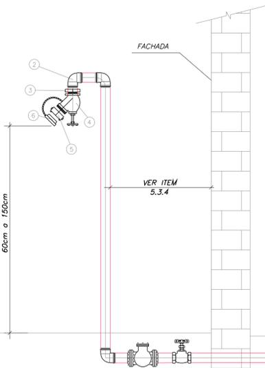
**DISPOSITIVO DE RECALQUE TIPO COLUNA.**
